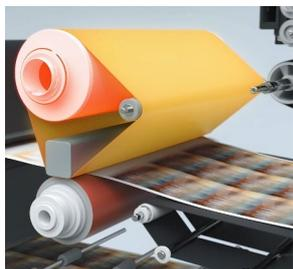
La nouvelle unité de fixation est composée en partie supérieure d'un rouleau chauffant autour duquel une courroie évoluée et d'un cylindre de pression en partie basse. La courroie transfère la chaleur du rouleau vers le média sur lequel le toner a été déposé. Un patin permet d'augmenter la zone de contact de chauffe du média sans en ralentir sa vitesse d'impression même pour les grammages les plus important.
