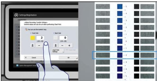
Le réglage de la tension de transfert secondaire de l'imagePRESS permet de fixer le toner dans les creux et autres interstices des papiers structurés. Cette opération est simplifiée grâce à l'impression automatique des pages de test permettant à l'opérateur de choisir le résultat qui lui convient.
