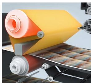
La nouvelle unité de fixation est composée en partie supérieure d'un rouleau chauffant autour duquel une courroie évoluée et d'un cylindre de pression en partie basse. La courroie transfère la chaleur du rouleau vers le média sur lequel le toner a été déposé. Un patin permet d'augmenter la zone de contact de chauffe du média sans en ralentir sa vitesse d'impression même pour les grammages les plus importants.
